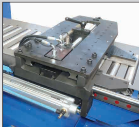
CU WK II Push-Pull: Bei bereits auf Länge zugeschnittenen Material ist das Abarbeiten ohne Reststück mit dieser Option möglich
