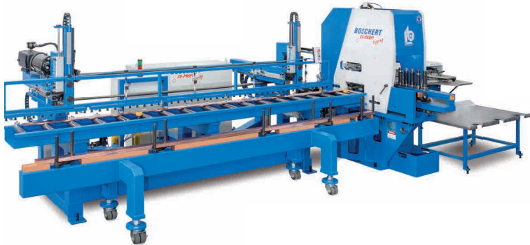
Cu Profi Belader: Für das automatische Beladen mit pneumatischen Saugarmen. (4 oder 6 mm)
