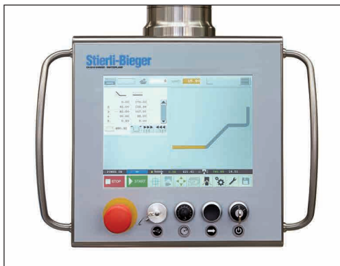
Moderne grafische Touch-Screen CNC-Steuerung mit schneller Dialog-Programmierung und integrierter Formenbibliothek
