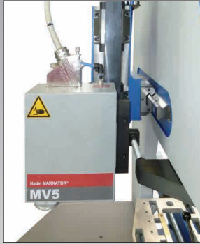
CuProfi und CU WK II Markiervorrichtung: für das Beschriften der Fertigteile
