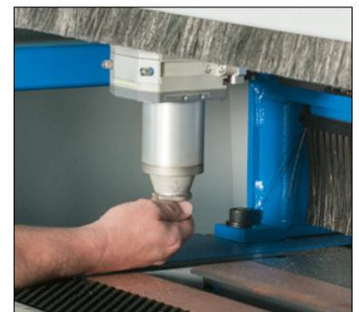
Düsenwechsel am Laserkopf
