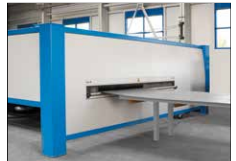
Seitliche Beladung der Bleche bei einer Umhausung
