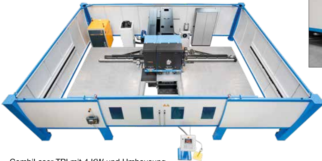
CombiLaser TRI mit 4 KW und Umhausung
