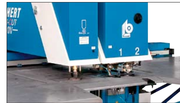
Zusätzliches Maschinengestell Ermöglicht ein schwingungsfreies und unabhängiges Arbeiten der Plasmaanlage.
