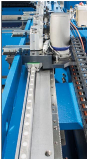
Servogetriebemotor mit Präzisionszahnstangenantrieb.
