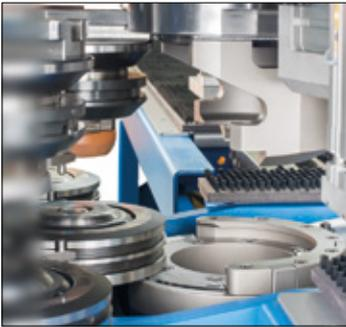
Mit dem Werkzeugwechsler können Werkzeugwechselzeiten von 3-5 Sekunden erreicht werden. In Verbindung mit dem Revotool sind auch Werkzeugwechsel unter einer Sekunde möglich.
