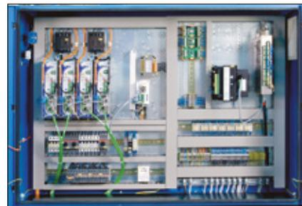
Frei zugängliche Anbringung der elektrischen Komponenten wie Digitalregler, Ventilationskühlung, Trafo und Steuerung
